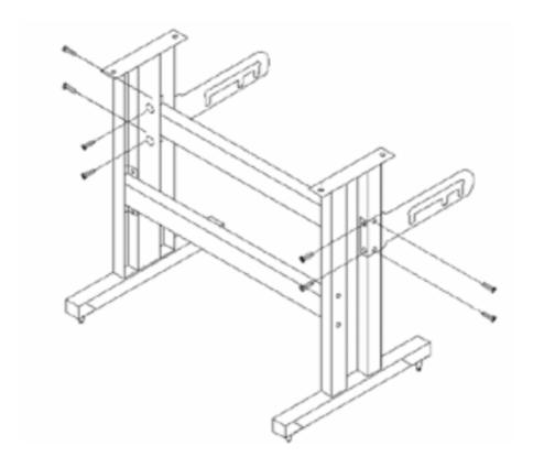
Der Standfuß für Ihren Secabo Schneideplotter (60er und 120er) lässt sich einfach aus den mitgelieferten Teilen analog zur obigen Explosionszeichnung zusammenbauen.
