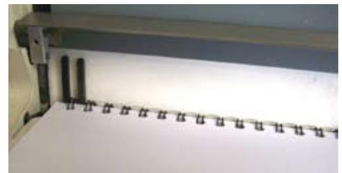
4. Das Bindeelement ist korrekt geschlossen
