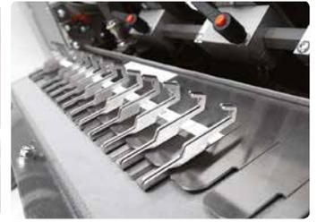
Buchhaltevorrichtungen halten den vorgestanzten Buchblock wenn dieser in der Maschine positioniert wird. Sie stimmen jeweils mit den verwendeten Spiraldurchmessern überein. Die Buchhaltevorrichtungen sind sicher im System aufgebaut.
