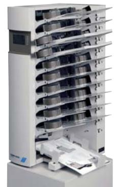
**Zusammentragturm Modell C 510** mit 10 Zuführungen und **Modell AC 510** mit zusätzlicher seitlicher Blasluftunterstützung (Air Separation/optional) können auch selbständig als reine Sammelstationen mit eigener Ablage, z.B. für die Bildung von Formularsätzen, genutzt werden.
